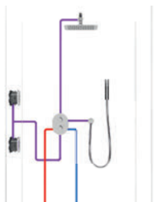
Vývod pro ruční a hlavovou sprchu v kombinaci s max. 2 oplachovými tryskami.
