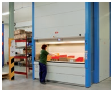
KARDEX. Velkokapacitní automatizovaný skladovací systém.
