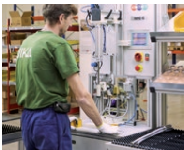
Vzduchový test na montážní lince.
