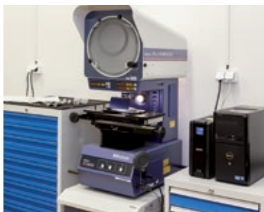
Profilový projektor. Laboratoř oddělení kvality.
